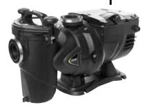
Насосы со встроенным префильтром с электронным управлением для бассейнов идеально подходят для циркуляции и фильтрации воды в плавательных бассейнах. Технология частотного преобразователя в сочетании с энергоэффективным синхронным электродвигателем с постоянно встроенными магнитами в роторе, охлаждаемым перекачиваемой жидкостью, обеспечивает минимальное энергопотребление и низкий уровень шума.
