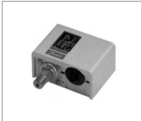
Прессостаты типа KPI — электромеханические реле давления с изменяемым дифференциалом, предназначенные для регулирования давления жидких и газообразных сред, а также сигнализации в различных промышленных установках. Например, KPI могут использоваться в узлах подпитки отопительных и других систем теплоснабжения зданий, присоединенных к наружным тепловым сетям по независимой схеме (через водоподогреватели).
