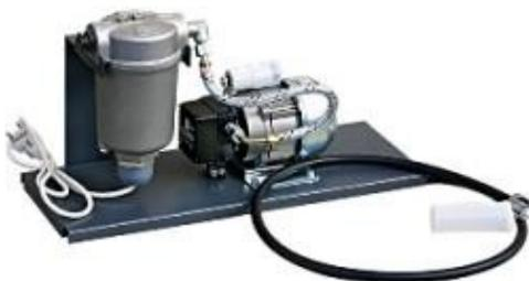
Помимо компрессора, горелки «**Kroll**» необходимо укомплектовать **фиспакетом**, который включает в себя обслуживаемый топливный фильтр с фильтрующим элементом, изготовленным из нержавеющей сетки с ячейкой 100 мкм, который установлен в разборный дюралюминиевый корпус, топливный насос, для подачи масла в горелку, электромотор привода насоса. Все элементы компактно размещены на металлической платформе. Топливозаборная арматура с поплавком так же входит в комплект горелки «**Kroll**».
