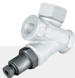
BDV. Клапан продувки. При открытом клапане нижней продувки частицы грязи в сетчатом фильтре выдуваются.
