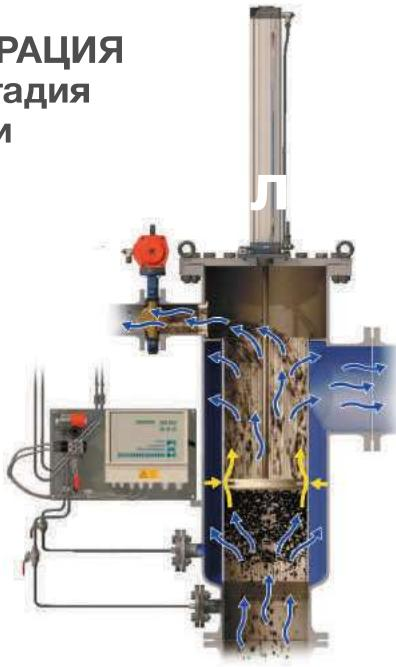
Очищающий диск опускается внутрь сетки, создавая эффект Бернулли, отрывая загрязнения от сетки. Диск опускается только на 2/3 длины фильтрующей сетки, проходное сечение фильтра свободно, процесс фильтрации продолжается непрерывно. Частицы загрязнений удаляются в сбросной трубопровод.
