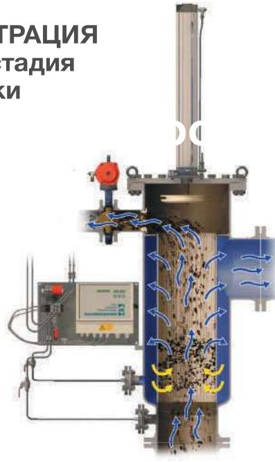
Диск возвращается на прежнее место, скорость среды увеличивается в нижней 2/3 части фильтра, снижая статическое давление внутри сетки по сравнению с давлением снаружи сетки (в чистой зоне), образуется противоток, отрывающий остатки загрязнений в нижней 2/3 части фильтра. Процесс очистки завершен.
