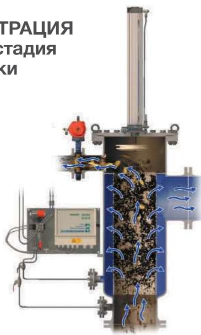
Срабатывает таймер или реле давления, открывается сбросной клапан, через который подъемным потоком начинают уноситься наиболее крупные частицы загрязнений.
