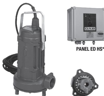
Погружной канализационный насос с чугунным корпусом гидравлики, корпусом двигателя и регулируемым рабочим колесом. Режущий механизм - микролитая сталь. Вал, ручка, фильтр, болты и винты – нержавеющая сталь. Торцевое уплотнение - карбид кремния, масляная камера с возможностью визуальной проверки.
