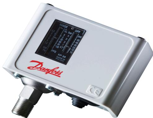
Реле давления типа КР оснащены однополюсной двухпозиционной контактной группой (SPDT). Положение контактов переключателя зависит от настройки реле и давления контролируемой среды.
