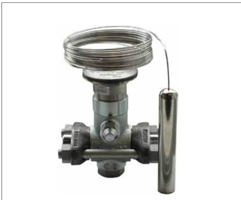
Терморегулирующие клапаны TEA контролируют поступление жидкого хладагента в испарители. Расход хладагента регулируется по его перегреву на выходе из испарителя.
