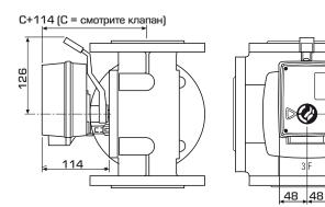
Установочные размеры для приводов серии 90 со смесительными клапанами ESBE серий MG, G, F, T/TM, H/HG и BIV
