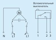
Привод с предварительно установленным вспомогательным выключателем, Арт. номер.
