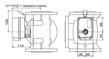
Установочные размеры для приводов серии 90 со смесительными клапанами ESBE серий MG, G, F, T/TM, H/HG и BIV
