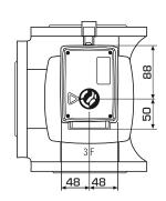
Установочные размеры для приводов серии 90 со смесительными клапанами ESBE серий MG, G, F, T/TM, H/HG и BIV
