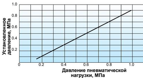
В общем случае зависимость установочного давления от давления воздуха пневматической нагрузки имеет следующий вид. Значение установленного давления может незначительно отличаться в зависимости от рабочих условий. В этом случае необходимо скорректировать давление пневматической нагрузки.
