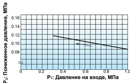
На данном графике показана зависимость пониженного давления при изменении давления на входе клапана с 0,3 МПа до 1 МПа при установленном пониженном давлении 0,1 МПа.
