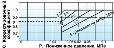
Если входное давление превышает 0,7 МПа, а коэффициент понижения давления составляет более 10:1, следует определить корректировочный коэффициент по приведенному выше графику и умножить его на значение  $C_v$ .
