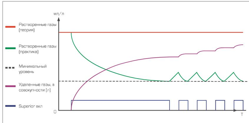
Это упрощенное представление практических измерений на различных установках. Содержание газа уменьшается до минимального значения во время исходной деаэрации, после ввода установки в эксплуатацию или при перезапуске установки. Затем Superior выключается, и содержание газа постепенно начинает увеличиваться снова. При включенном на некоторое время Superior содержание газа остается на минимальном уровне. Это позволяет избежать проблем.
