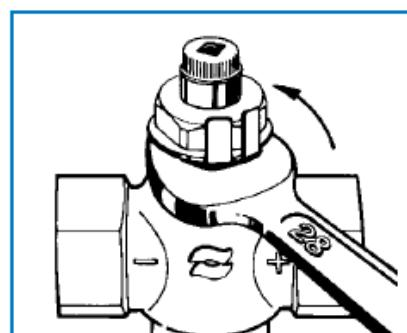
Рис. 4. Используя гаечный ключ 28 мм, вывинтить верхнюю часть клапана, вынуть терmostатический элемент в комплекте с пружиной и диском. Промыть водой и вернуть в исходное положение. Собрать клапан.
