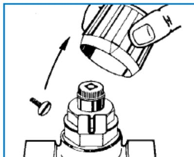
Рис. 2. Вывинтить стопорный винт и снять маховик, следя за тем, чтобы не сбить установку контрольного штыря.
