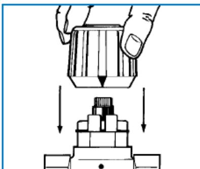
Рис. 3. Вновь надеть маховик, так чтобы указатель V совпал с выпуклой риской на корпусе клапана. В этой позиции маховик зафиксирован.
